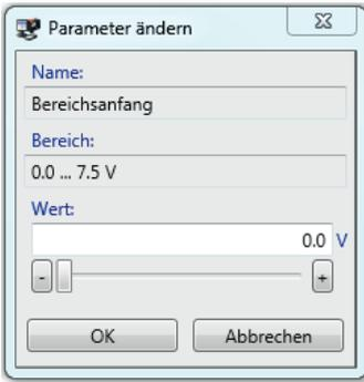
**Bild 9:** *Parameter, Beispiel hier: Bereichsanfang für Eingangssignalbereich*
