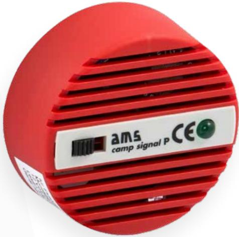
Das CAMP SIGNAL P spürt Flüssiggas (Propan/Butan) und Stadtgas/Erdgas (Methan) auf, weit bevor ein explosionsfähiges Gemisch entsteht. Das Gerät ist zur Verwendung in Wohnmobilen und Caravans vorgesehen. Die Warnung erfolgt durch ein lautes akustisches Alarmsignal. Das Ziel ist, die betroffenen Insassen zu warnen und auf die Gefahr einer zu hohen Gaskonzentration aufmerksam zu machen.
