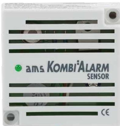
Der Zusatzsensor detektiert geringste Konzentrationen gefährlicher Narkosegase, weit bevor sie die betäubende Wirkung entfalten. Zudem werden Flüssiggas (Propan/Butan) und Stadtgas/Erdgas (Methan) aufgespürt, weit bevor ein explosionsfähiges Gemisch entsteht.
