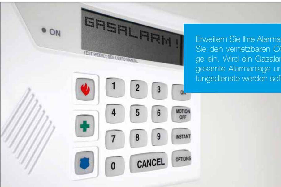
Erweitern Sie Ihre Alarmanlage um ein Stück Sicherheit: Binden Sie den vernetzbaren CO-ALARM S/200-C in Ihre Alarmanlage ein. Wird ein Gasalarm ausgelöst, aktivieren Sie sofort die gesamte Alarmanlage und Sie und die angeschlossenen Rettungsdienste werden sofort gewarnt.
