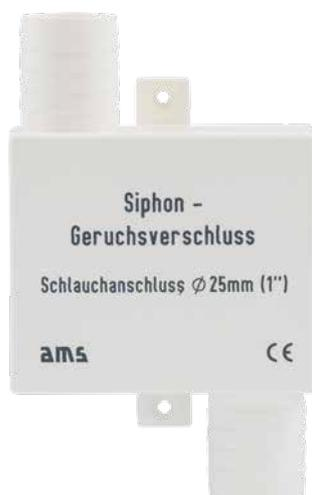
Der Siphon-Geruchsverschluss verhindert Gerüche aus dem Abwassertank. Er wird einfach zwischen dem durchtrennten Abwasserschlauch eingesetzt. Die Reinigung erfolgt durch Ausspülen mit Wasser. Der Siphon-Geruchsverschluss ist für Schlauchgrößen von Ø 19mm (3/4") und von Ø 25mm (1") lieferbar.
