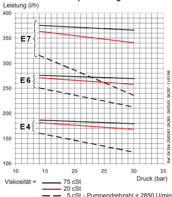
In den dargestellten Kurven ist bereits eine Abnutzung des Getriebes berücksichtigt. Achten Sie deshalb darauf, daß Sie bei der Wahl der Getriebekapazität, die Pumpe nicht überdimensionieren.
