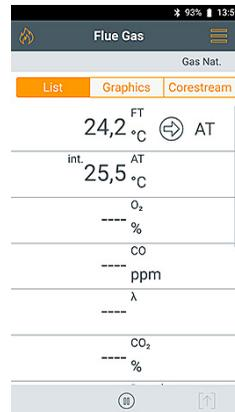
▶ Die Verbrennungstemperatur wurde gespeichert und wird für die Kalkulation berechneter Werte verwendet.
