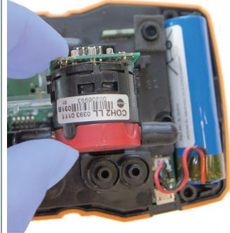
2 Schlauchverbindungen vom defekten Sensor der Brücke abziehen.
