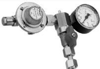
Mit der **UPE-300** und unter Zuhilfenahme einer Ölsaugpumpe wird der geforderte Prüfunterdruck von -300 mbar erzeugt. Fällt der auf dem Vakuummeter angezeigte Unterdruck während der Prüfzeit von mindestens 10 Minuten nicht um mehr als 30 mbar ab, so ist die Ölleitung „dicht“.
