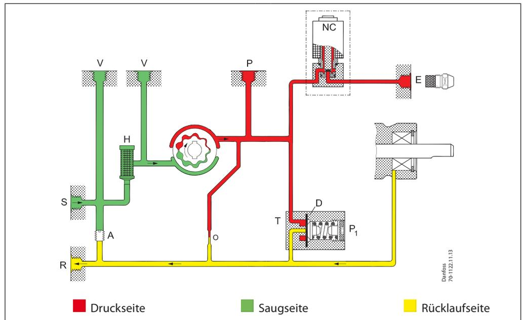
Über den Sauganschluss (S) wird das Öl über das Filter (H) in den Zahnradsatz gesaugt, wo der Druck erhöht wird. Wenn Spannung an das NC-Ventil (normally closed) gelegt wird, öffnet es und gibt das Öl zur Düse frei. Durch die Membrane (D) im Druckregler (T) wird der an der Druckregelschraube (P1) eingestellte Druck konstant gehalten.
